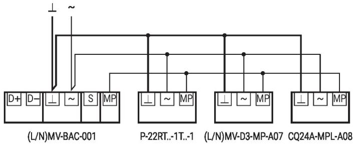
Conexión del sensor (temperatura o CO<sub>2</sub>)
