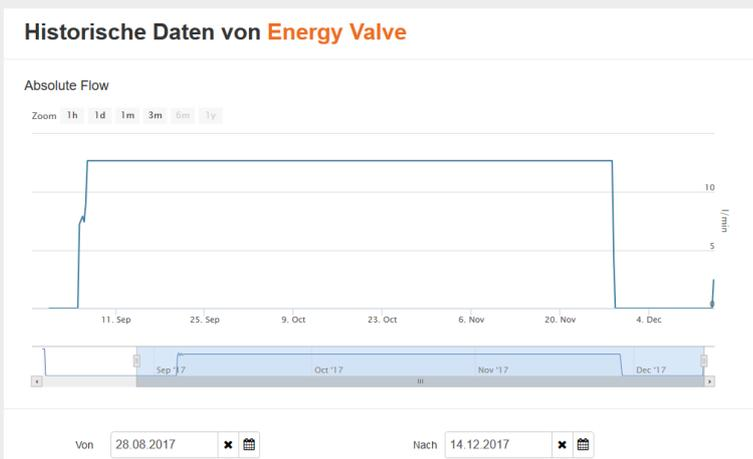
8. Angezeigte Daten mittels Bildlaufleiste und/oder Datumsauswahl filtern
