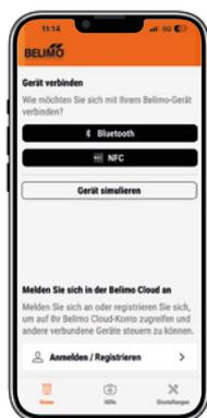
Die NFC (Near Field Communication)-Schnittstelle auf den Geräten von Belimo erlaubt die einfache und schnelle Konfiguration, Bedienung und Fehlerbehebung der Geräte mithilfe von Belimo Assistant 2.
