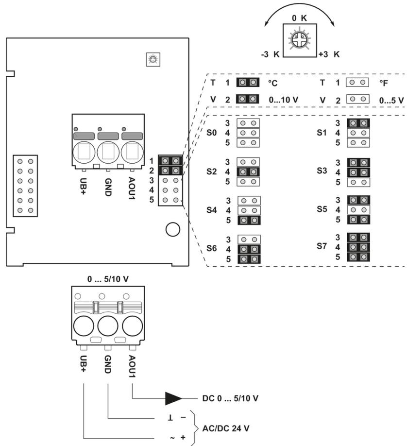
通过跳线的变化来调整量程范围，输出值将在跳线变更后两秒激活。
